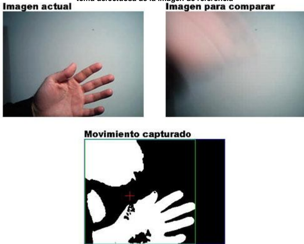
Figura 7: Ejemplo de método SIR, en donde se hizo una toma defectuosa de la imagen de referencia
