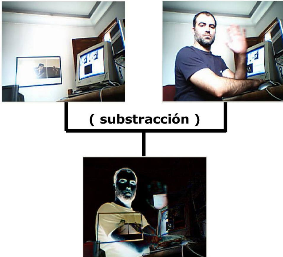
Figura 1: captura del movimiento mediante substracción de video. La imagen de la izquierda es el fondo, la de la derecha es un fotograma de la escena actual y debajo el resultado de la substracción.
